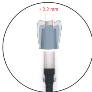
Le diamètre de la cheville utilisée avec la version à diamètre réduit doit être **>2,2 mm.**
